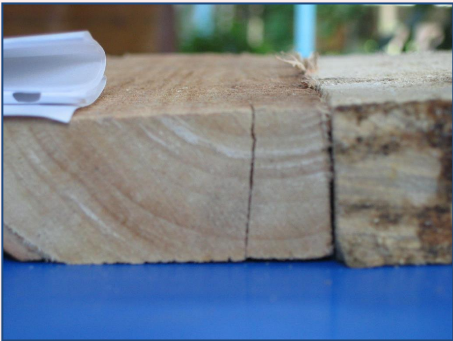
รูปที่ 6 การแตกของไม้ยางพาราที่ไม่ผ่านการแช่ PEG 1000 หลังการอบเป็นวันที่สี่
