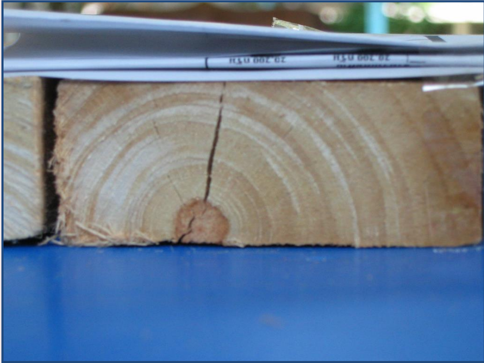
รูปที่ 5 การแตกของไม้ยางพาราที่ไม่ผ่านการแช่ PEG 1000 หลังการอบเป็นวันที่สี่
