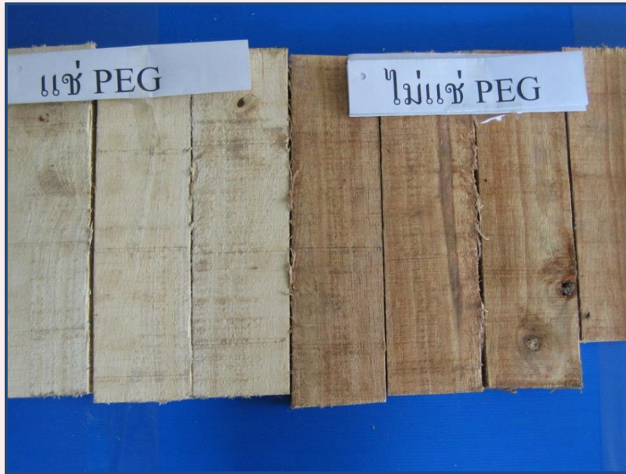
รูปที่ 7 สีของไม้ยางพาราที่ผ่านและไม่ผ่านการแช่ PEG 1000
