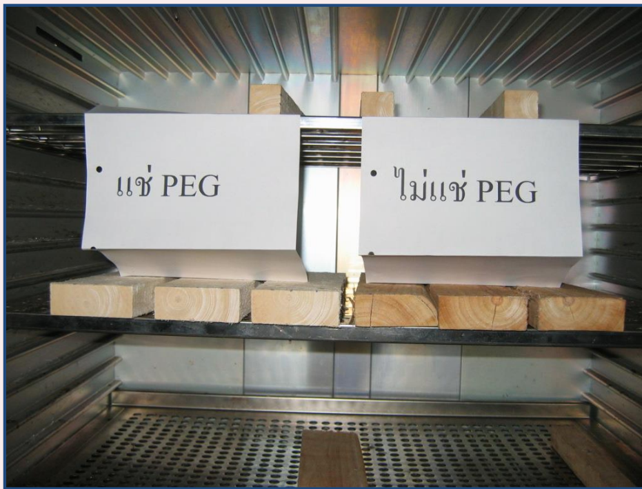
รูปที่ 4 ไม้ยางพาราที่ผ่านและไม่ผ่านการแช่ PEG 1000
